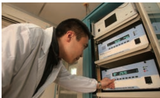
图 8-25 环境保护工程师在监测站点查看PM 2.5 监测设备运行情况
