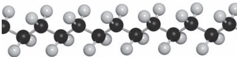
图7-12 聚乙烯的分子结构模型（局部）
