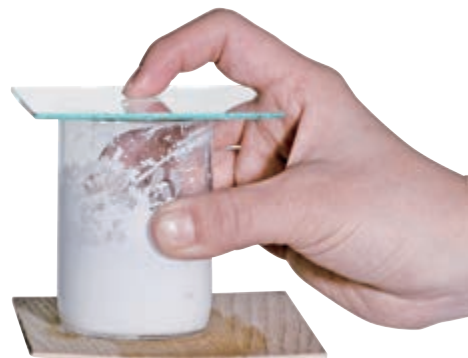
图 6-2 化学反应吸热使烧杯与木片间的水凝结成冰
