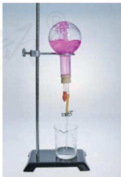
图5-11 氨溶于水的喷泉实验
