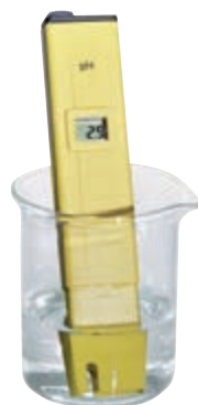
图5-17 用pH计测量水样的酸度
