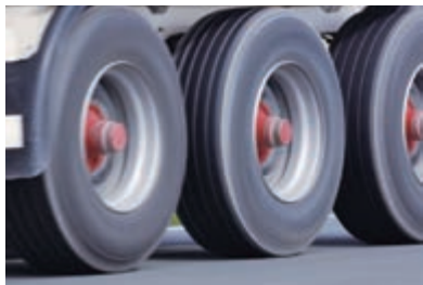
图7-14 硫化后的橡胶适合制造轮胎，加入炭黑可提高轮胎的耐磨性
