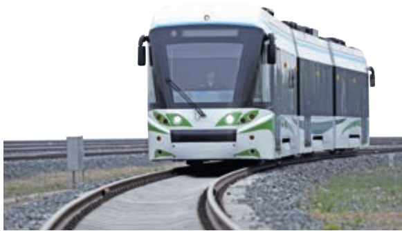
图6-13 我国研制的燃料电池和超级电容混合动力有轨电车
